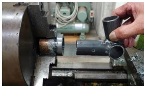
図 2 パイプの加工と調整
