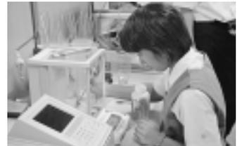
水質分析の実験用の硫化第一鉄の分量を計る
