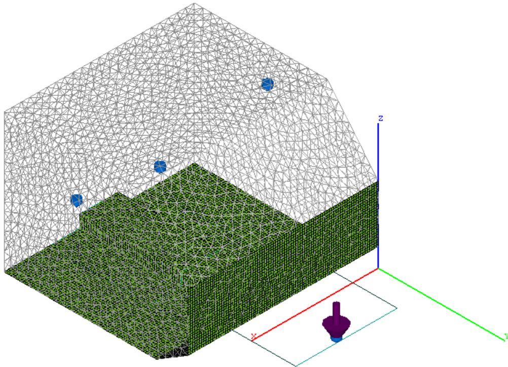
モデル化の一例：自動車構造を模擬したはり・薄板構造物と内部音場からなる構造を対象とした
