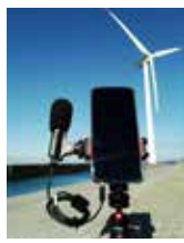
工学部工学科機械工学コースの本田巖教授と不動産技術工業、NPO法人長崎海洋産業クラスター形成推進協議会およびENEOSリニューアブルエナジー(株)が共同で開発した風力発電装置の翼の損傷を音響データで検出する国内初の技術「Chokai (チョーカイ)」のレンタルサービスを開始。この技術を使えば誰でも正確に検査し、損傷を早期に発見することができ、名前の由来は、検証地の「R.E.酒田風力発電所から望む「馬海山」。
