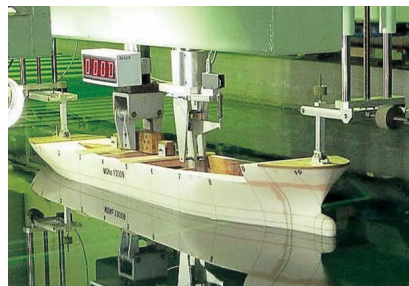
船舶の抵抗試験 Resistance test of a ship 施設名称：船舶海洋試験水槽 使用目的：船舶や海洋構造物の性能改善
