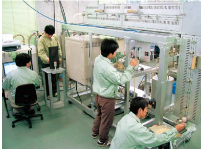
木質バイオマスのガス化実験装置 Facility for Bio-gasifier of wood
