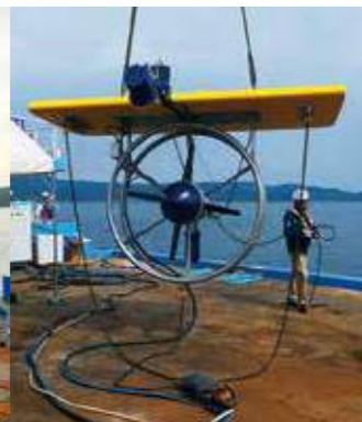
海中浮遊式の海流発電装置“シードラゴン”。グライダーのような海中翼と発電タービンから構成される
